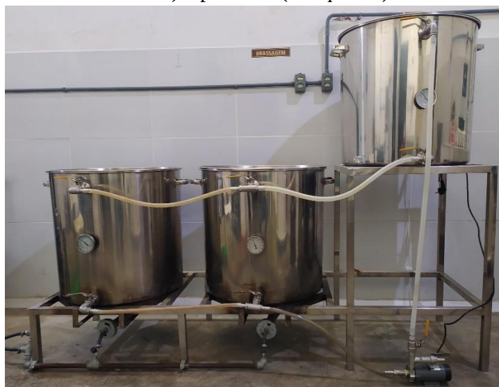
Figura 6 – Painelas de brassagem composta pelas painelas 1 (à direita), panela 2 (ao centro) e panela 3 (à esquerda).
