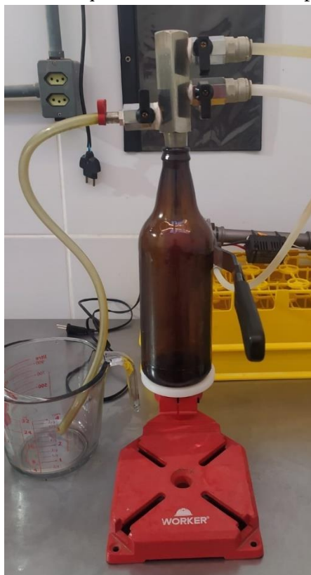
Figura 15 – Máquina de envase a contrapressão.
