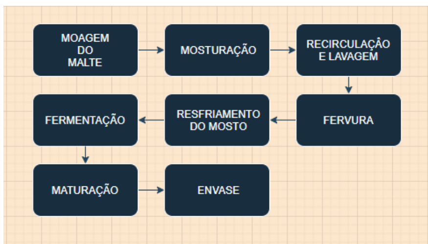
Figura 2 – Fluxograma do processo de produção da cerveja artesanal.
