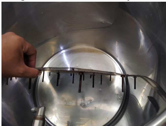
Figura 8 – Altura do fundo falso na panela 1.
