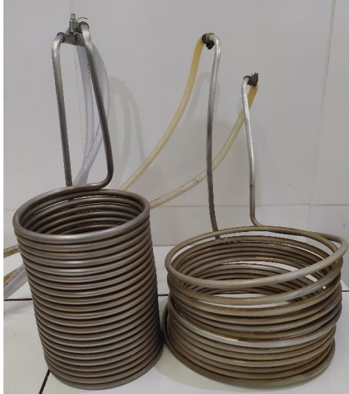
Figura 11 – Chillers utilizados na refrigeração.
