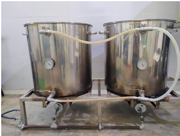
Figura 9 – Conexões entre as panelas 2 e 3 para a etapa de fervura.
