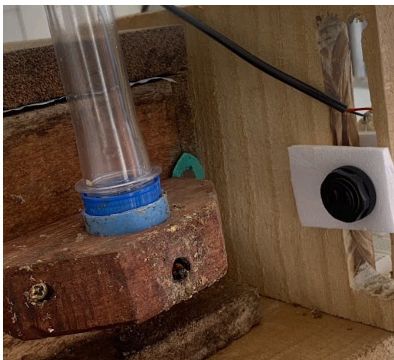
Figura 15: Sensor reflexivo apontando para entrada da caixa
