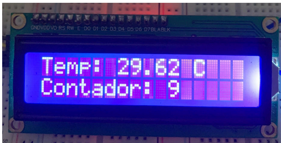
Figura 7: Display LCD 16x2 com módulo I2C soldado
