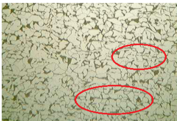
Figura 3: Microestrutura do aço ASTM A36 aumentado 20x
