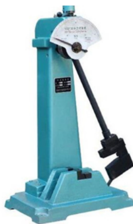
Figura 18: Máquina pendular utilizada no ensaio Charpy
