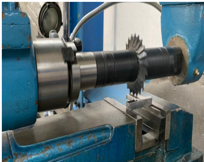
Figura 17: Usinagem do entalhe
