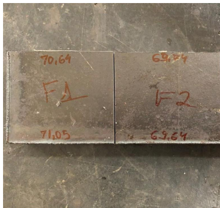
Figura 11: Amostras do aço A36 cortadas e prontas para o TTAT
