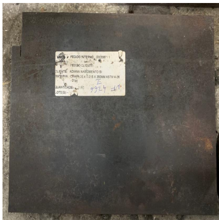
Figura 10: Chapa de aço A36
