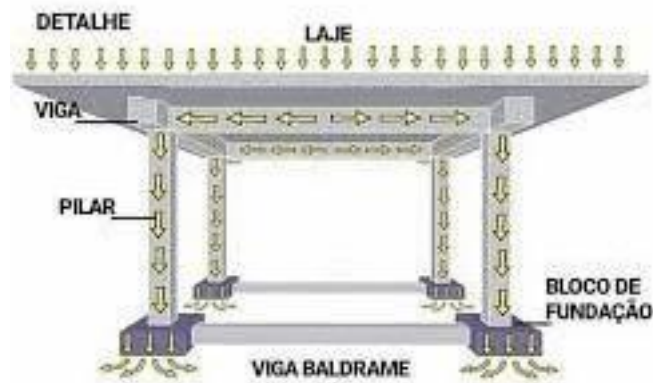
Figura 2.6 - Distribuição de carga em uma estrutura.
