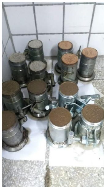
Figura 2. Corpos de prova após a realização da moldagem. (Autoria própria)
