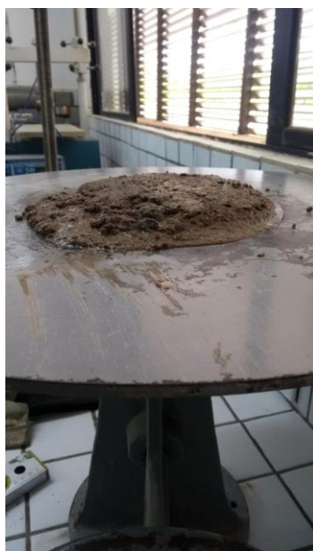
Figura 3. Ensaio na mesa de consistência. (Autoria própria)
