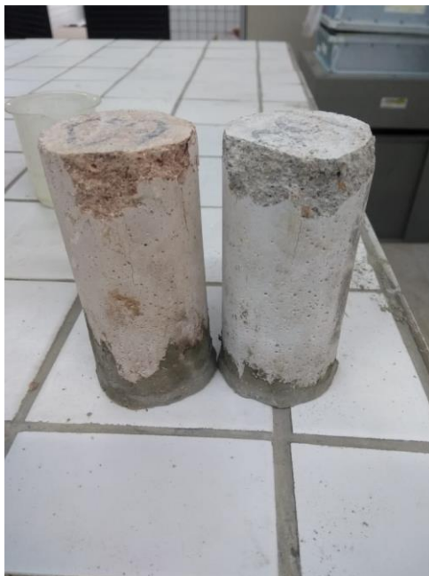
Figura 6. Comparação entre os corpos após o ensaio de resistência a compressão. (Autoria própria)
