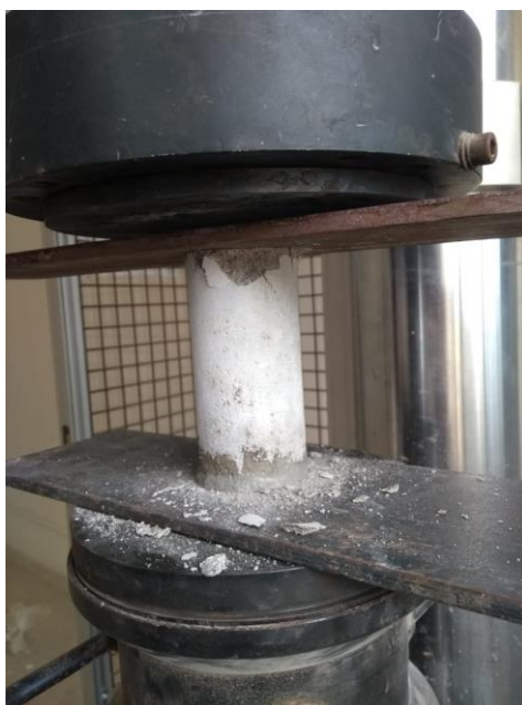
Figura 5. Corpo de prova rompido após o ensaio de resistência a compressão. (Autoria própria)
