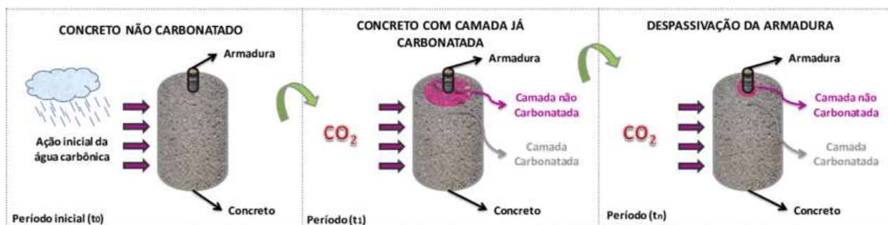
Figura 2. Representação da frente de carbonatação ao longo do tempo.
