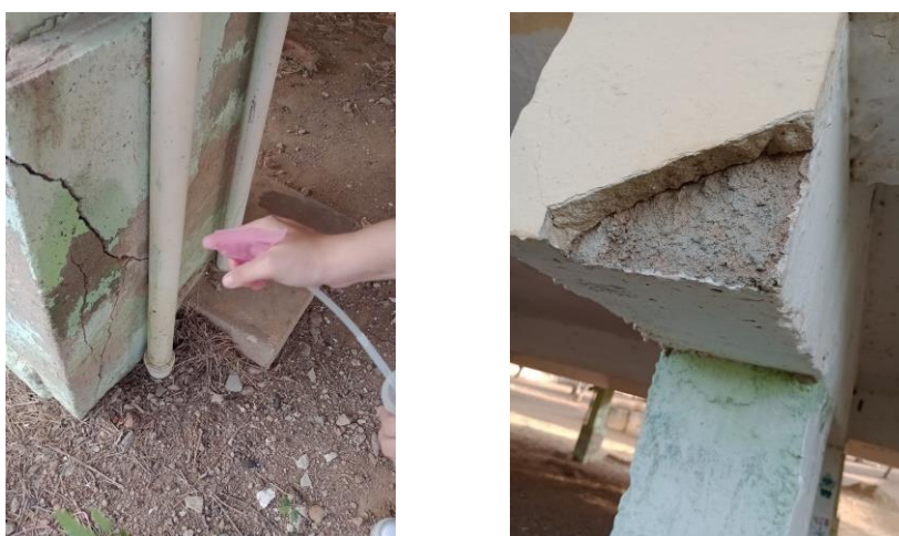
Figuras 18 e 19. Áreas analisadas com a fenolftaleína.
