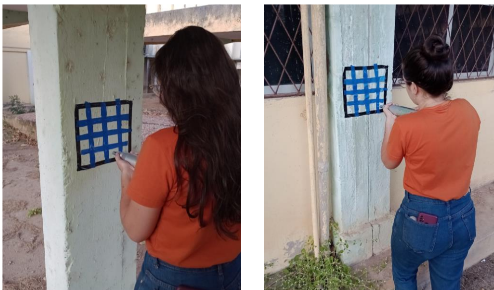
Figuras 10 e 11. Marcação do gabarito e ensaio de esclerometria.
