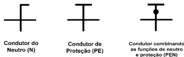
Figura 08: Simbologia para aterramentos.
