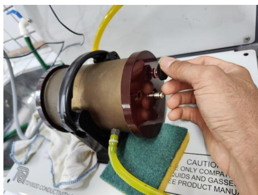
Figura 5 – Retirada dos parafusos da tampa da extremidade frontal. Fonte: (Autoria Própria)
