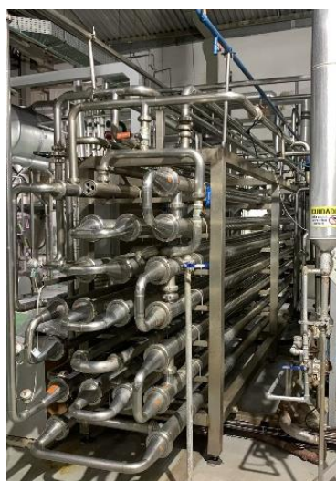
Figura 4 – Trocador de calor tubular para pasteurização de produtos (Autoria própria, 2022)
