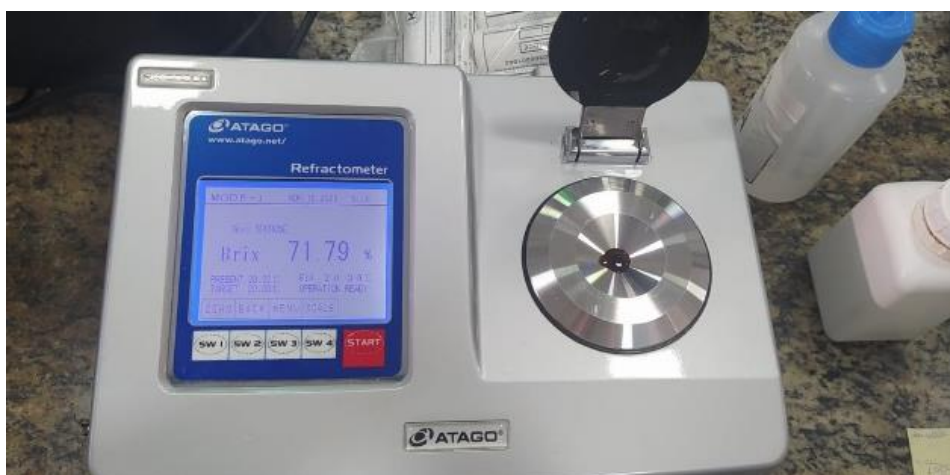
Figura 7 – Refratômetro utilizado para análise de grau Brix
