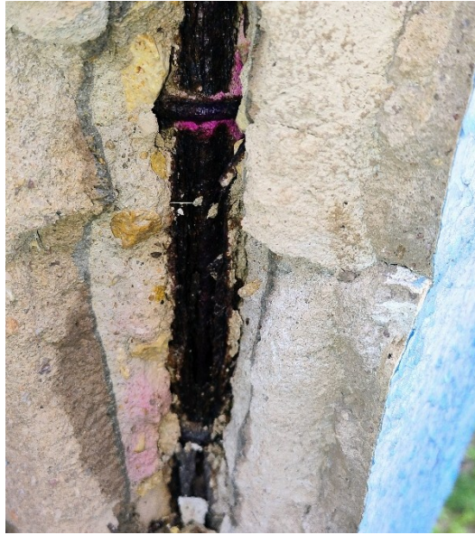
Figura 17 – Teste com indicador de fenolftaleína.
