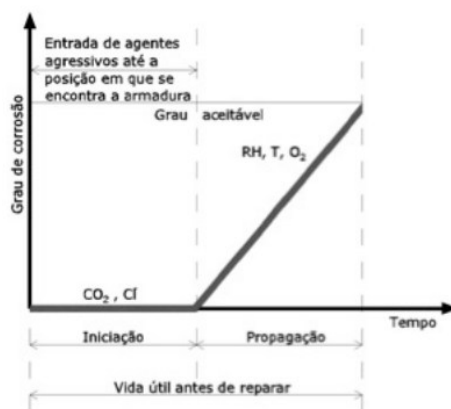
Figura 1 – Modelo de corrosão do concreto.
