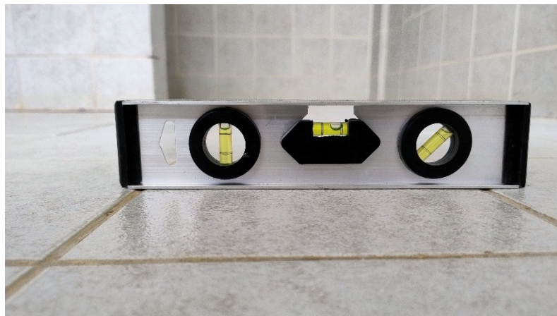
Figura 23 – Utilização do nível no piso do banheiro feminino.
