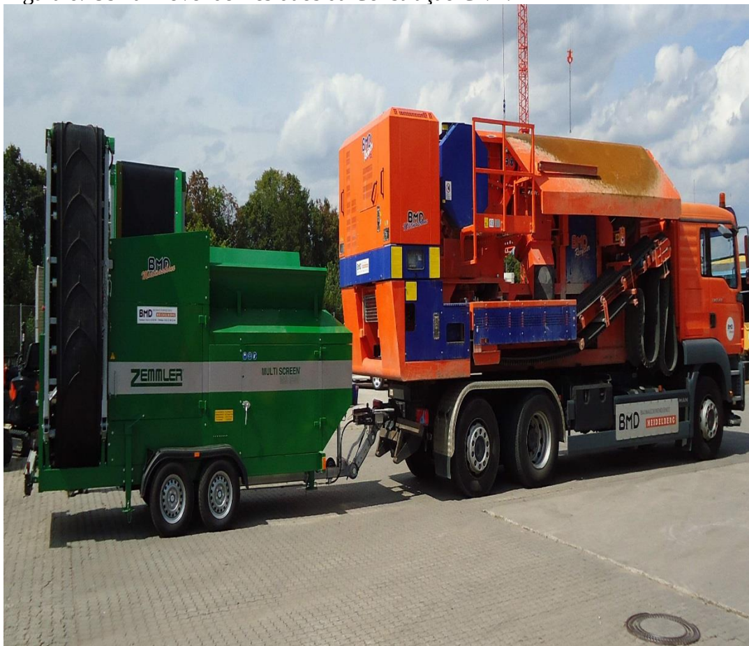
Figura 6: Usina Móvel de Resíduos da Construção Civil.
