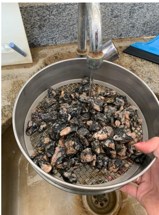
Figura 9 - Lavagem da amostra do agregado graúdo.
