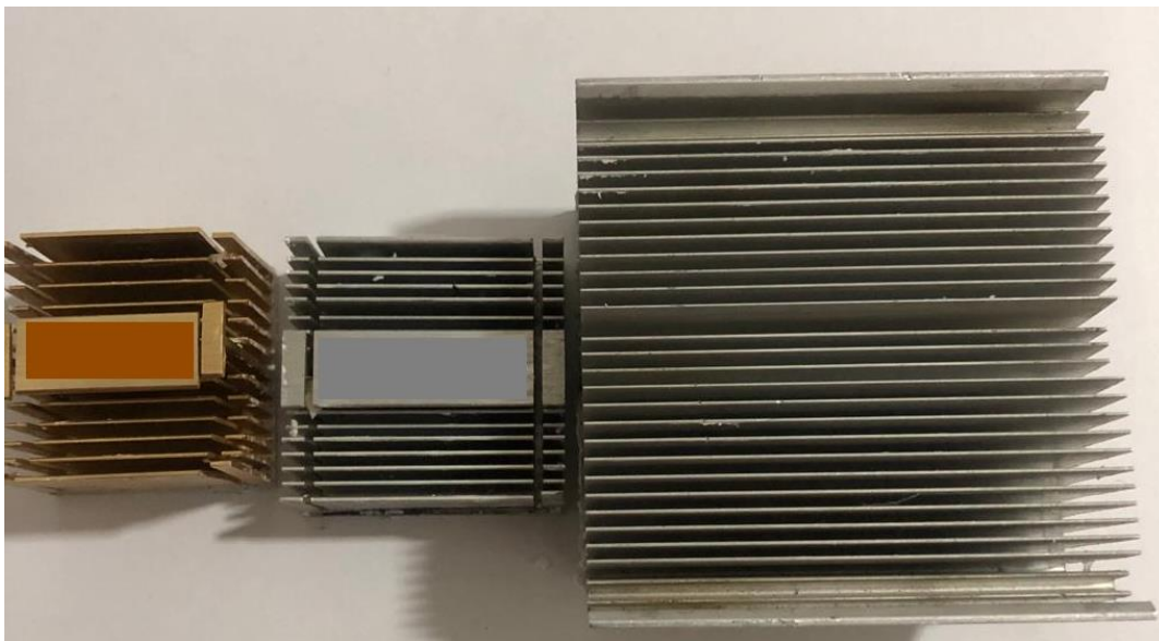
Figura 7 - Dissipadores de calor
