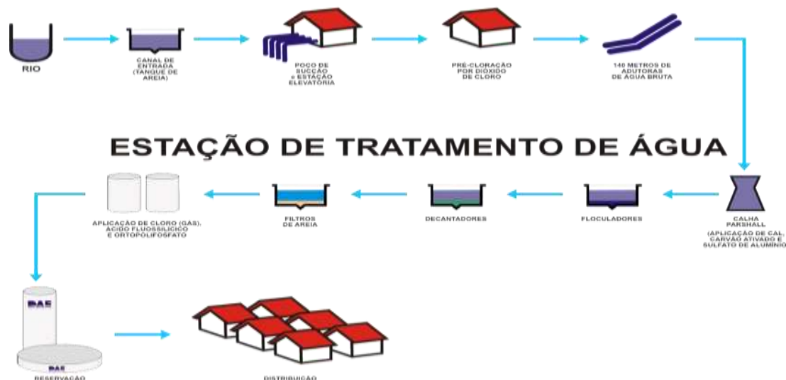
Figura 4: Esquema do sistema de abastecimento de água em estabelecimentos prediais
