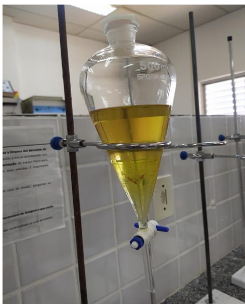
Figura 10: Separação de fases após a reação de transesterificação.
