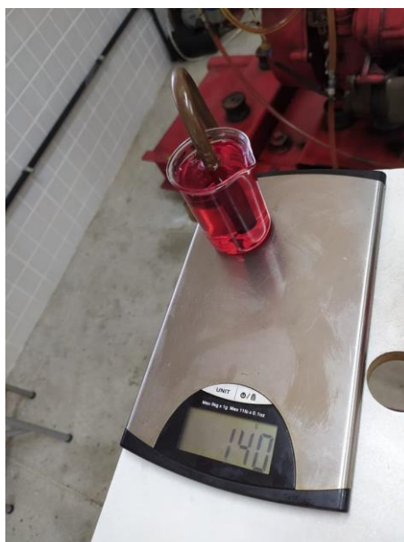
Figura 13: Processo de medição de consumo de combustível.
