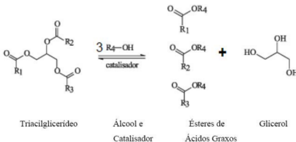
Figura 4: Reação geral da transesterificação.
