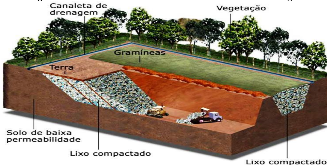
Figura 11 - Recobrimento dos resíduos com camada de solo e argila.
