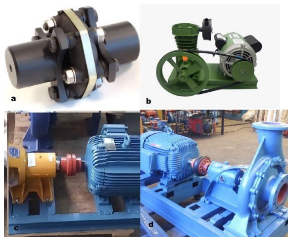
Figura 2. (a) Acoplamento direto [4]; (b) Compressor [5]; (c) Moto bomba [6]. (d) Moto bomba [6].
