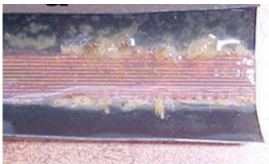
Figura 3. Formação do biofilme dentro (a) e fora (b) dos gotejadores obstruídos com água residuária da despolpa dos frutos do cafeeiro.
