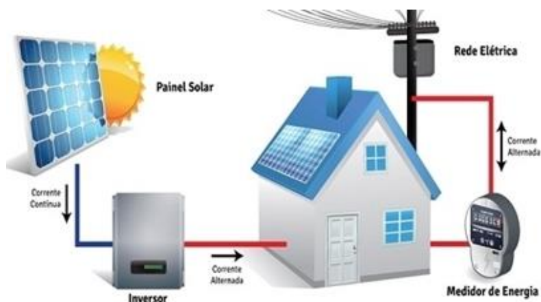
Figura 3: Exemplo de Sistema Fotovoltaico conectado a rede
