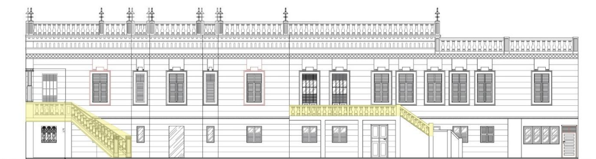
Figura 46: Fachada Lateral Direita - Balaústres e Guarda-corpos
