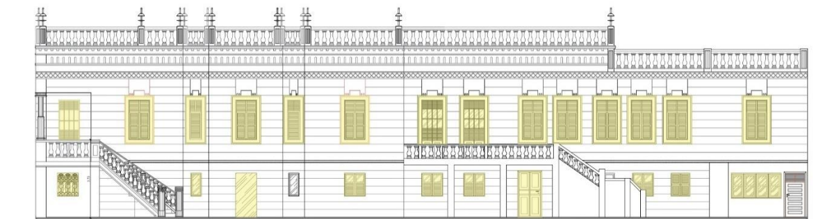
Figura 45: Fachada Lateral Direita - Esquadrias
