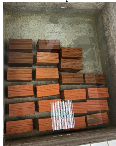
Figura 21b – Imersão de tijolos em tanque
