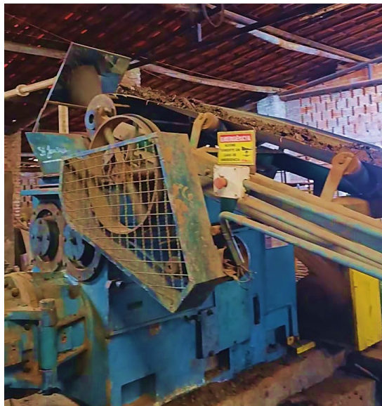
Figura 17a – Inserção da matéria-prima na esteira
