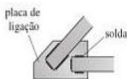
Figura 2 – Barras de uma treliça seguradas por meio de soldagem.
