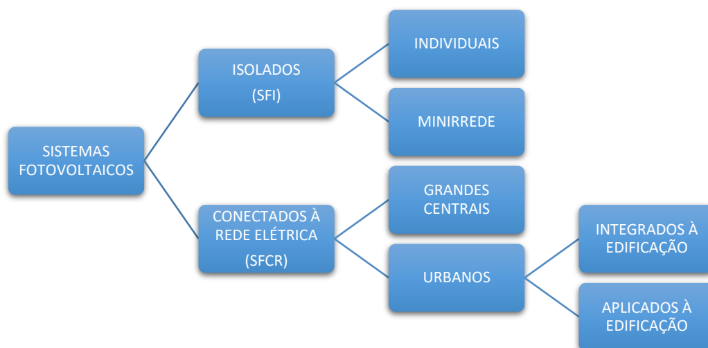
Figura 5 - Tipos de Sistemas Fotovoltaicos
