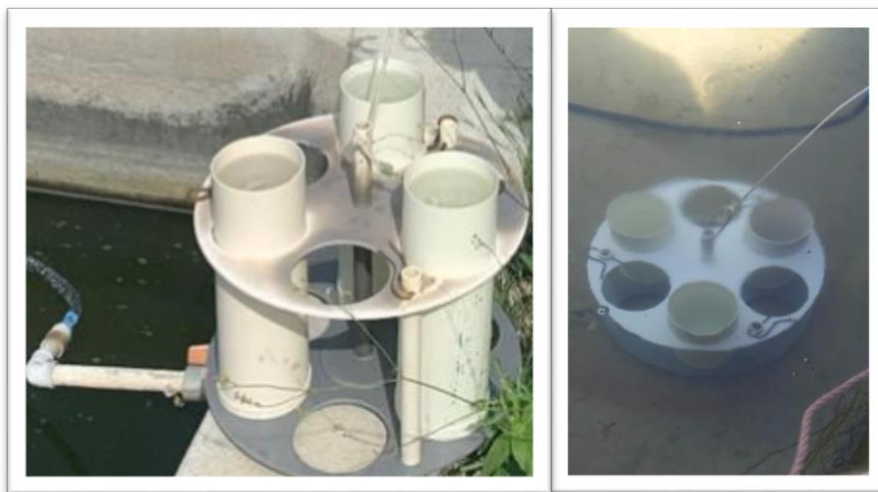
Apêndice 6. Câmaras de sedimentação (coletores de tripton) instaladas nas unidades experimentais.
