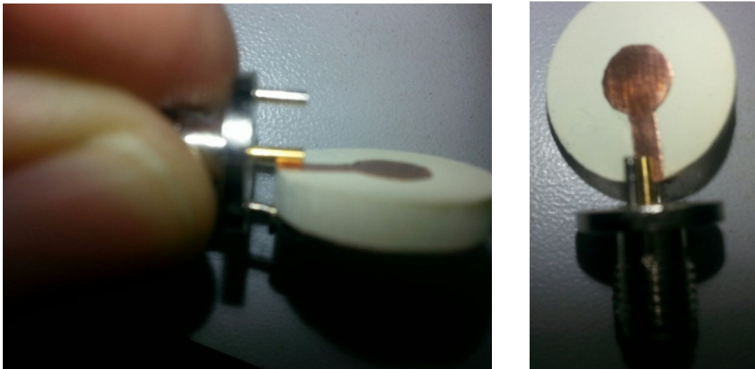
Figura 25 – Antena de Microfita com Patch na forma circular disposta sobre o substrato dielétrico a base de Pentóxido de Nióbio – \text{Nb}_2\text{O}_5 .
