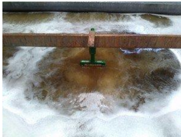
Figura 6: Imersão do material em soluções alcalinas. Fonte: Portal da Galvanoplastia.
