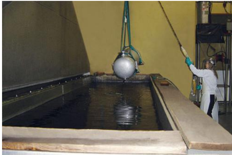
Figura 11: Passivação da peça Fonte: TREF STEEL.
