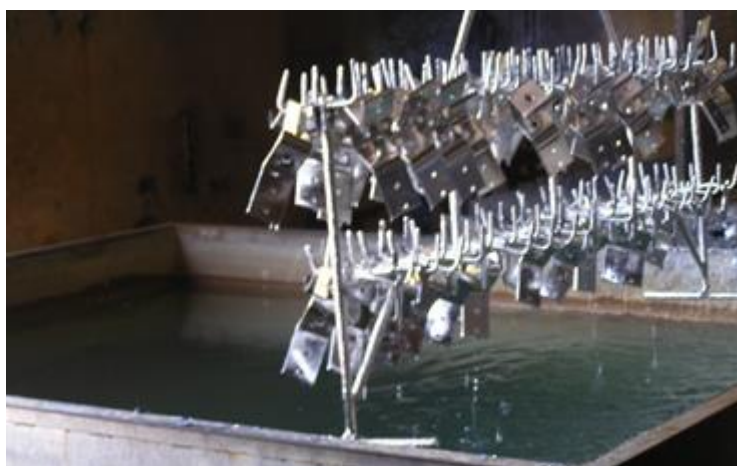
Figura 10: Imersão da peça em uma solução de sais de zinco. Fonte: Zinco Forte.
