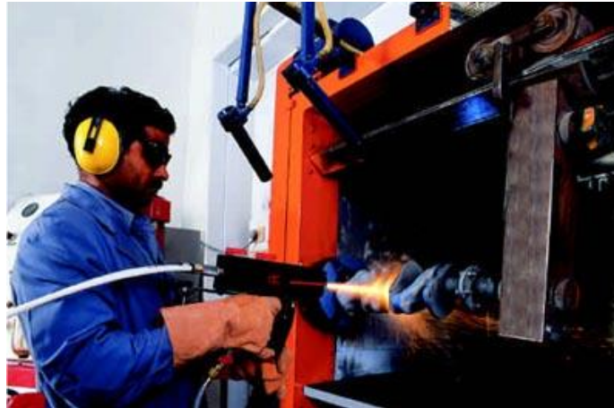
Figura 3: Aplicação da camada de zinco por aspersão térmica.
