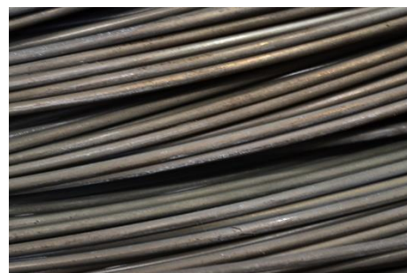
Figura 9: Material após a etapa de decapagem. Fonte: TREF STEEL.
