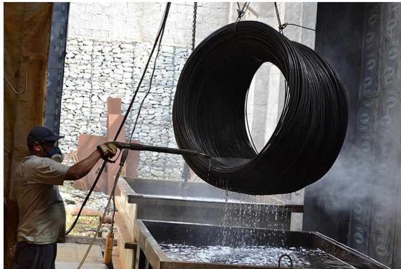
Figura 7: Processo de decapagem. Fonte: TREF STEEL
