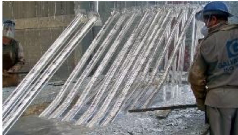
Figura 1: Galvanização por imersão à quente. Fonte: Galvaniza Ltda.
