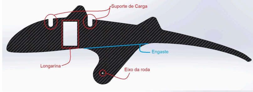
Figura 1. Trem de pouso e suas condições de contorno. (Autoria própria)
