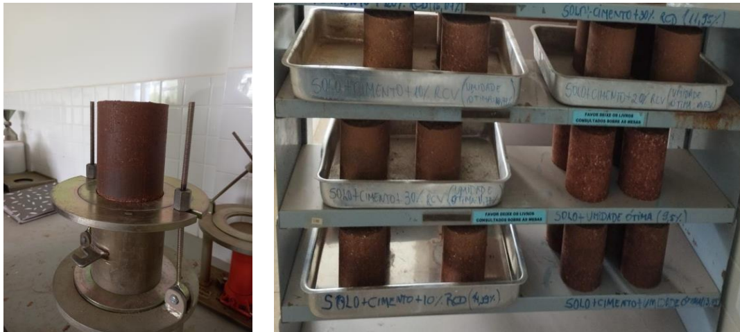
Figura 15 – Corpo de prova sendo retirado do cilindro e sendo armazenado.
