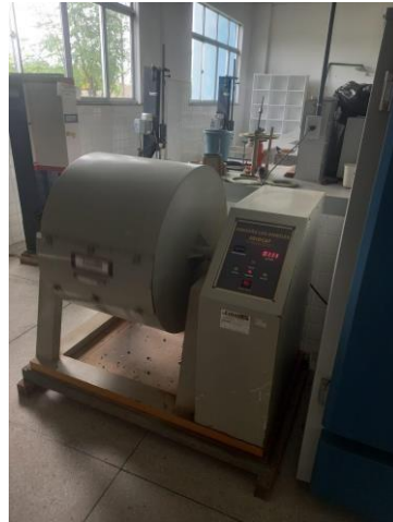
Figura 6 – Resíduo sendo triturado na máquina Abrasão Los Angeles.
