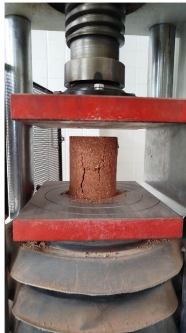
Figura 12 – Corpo de prova composto por solo após o ensaio de compressão.
