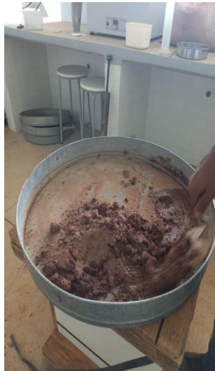
Figura 13 – Misturas para o ensaio de compactação.
