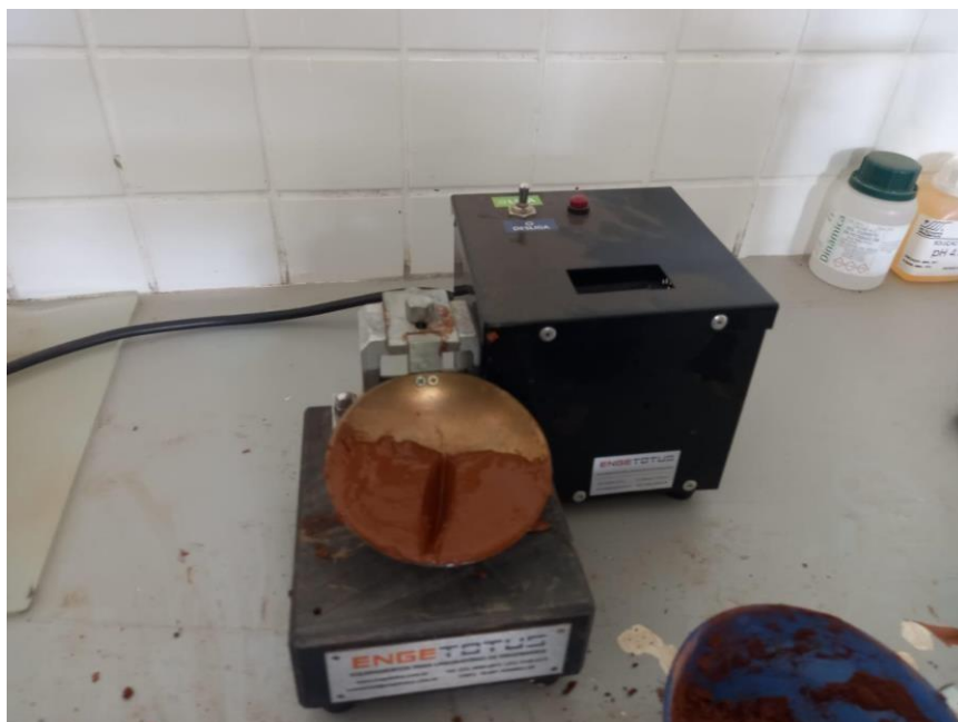
Figura 11 – Demonstração do ensaio do LL do RCV.
