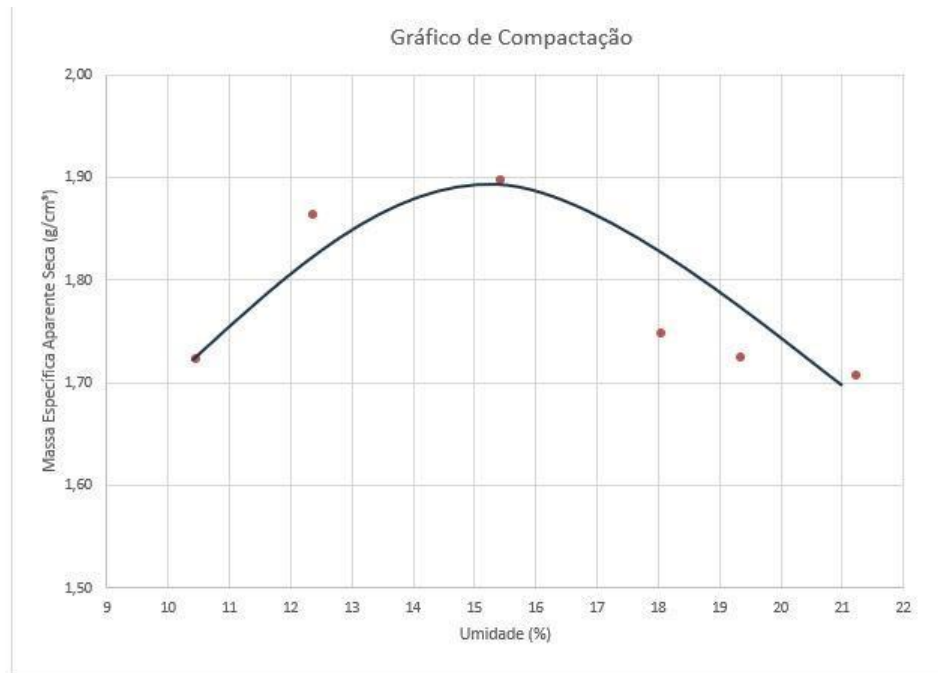
Figura 17 – Curva de compactação para o solo.
