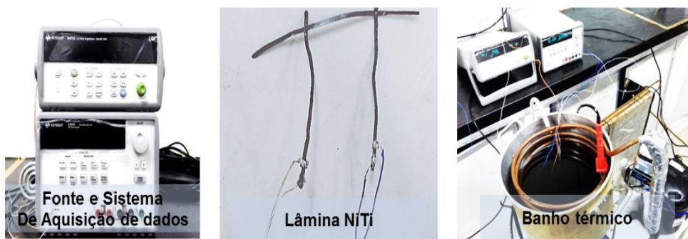
Figura 18- Lâmina de NiTi conectada a fonte elétrica e imersa no banho térmico
