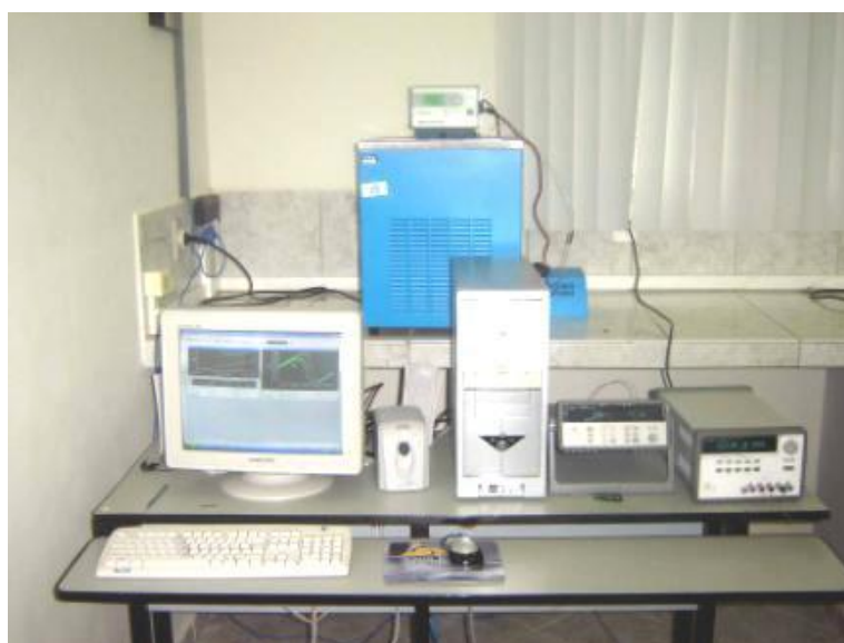
Figura 7- Plataforma experimental de medição da resistência elétrica em função da temperatura em amostras de LMF (SMRT).
