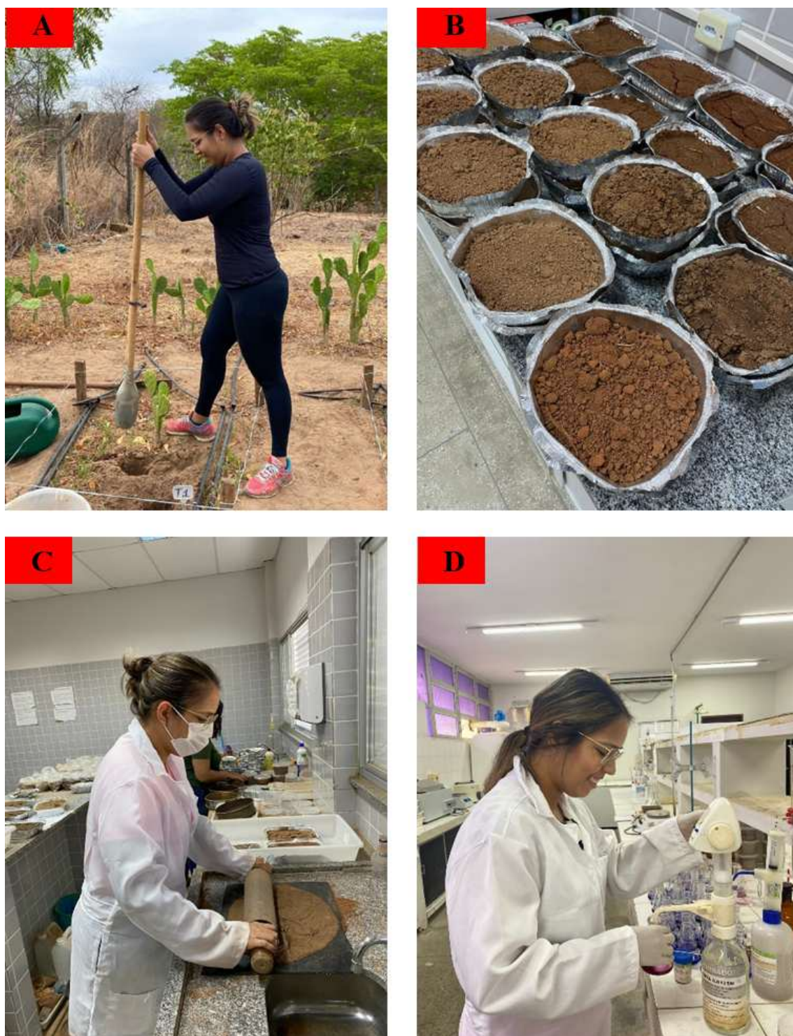
Figura 4. Coleta de amostras de solo (A); solos armazenados (B); obtenção da TFSA (C); análise de solo (D), no município de Mossoró, estado do Rio Grande do Norte, Brasil.
