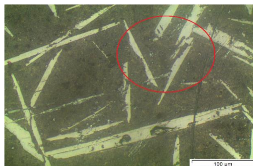
Figura 8 – microestrutura liga Al-Ti zoom 100x
