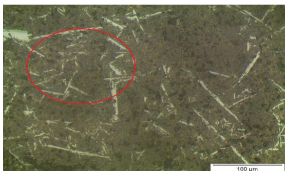
Figura 7 – microestrutura liga Al-Zn zoom 100x
