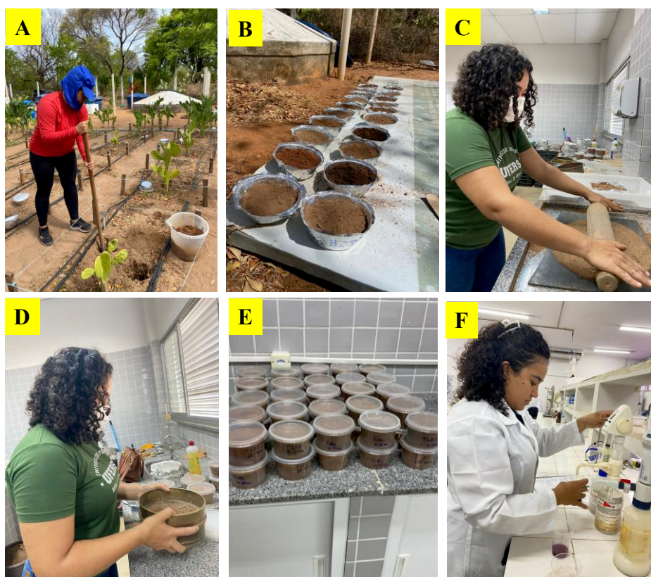
Figura 5. Coleta e preparo de amostras de solo em profundidades de 0-20 cm e 20-40 cm após 27 meses de cultivo de palma forrageira miúda. Fonte: Imagem de autoria própria (2025). Nota: Retirada de amostras de solo em cada parcela experimental (A); Amostras compostas de cada parcela nas profundidades de 20 e 40 cm (B); Destorroamento das amostras de solo (C); Peneiramento do solo com peneira de 2 mm para obtenção de TFSA (D); Armazenamento em potes de plástico (E); e Realização de análises (F).
