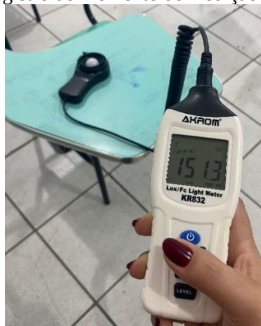
Figura 12 - Registro do momento de medição de iluminância.
