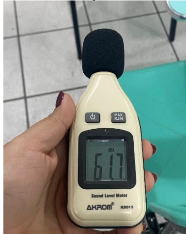
Figura 14 - Momento de medição de ruído com decibelímetro.
