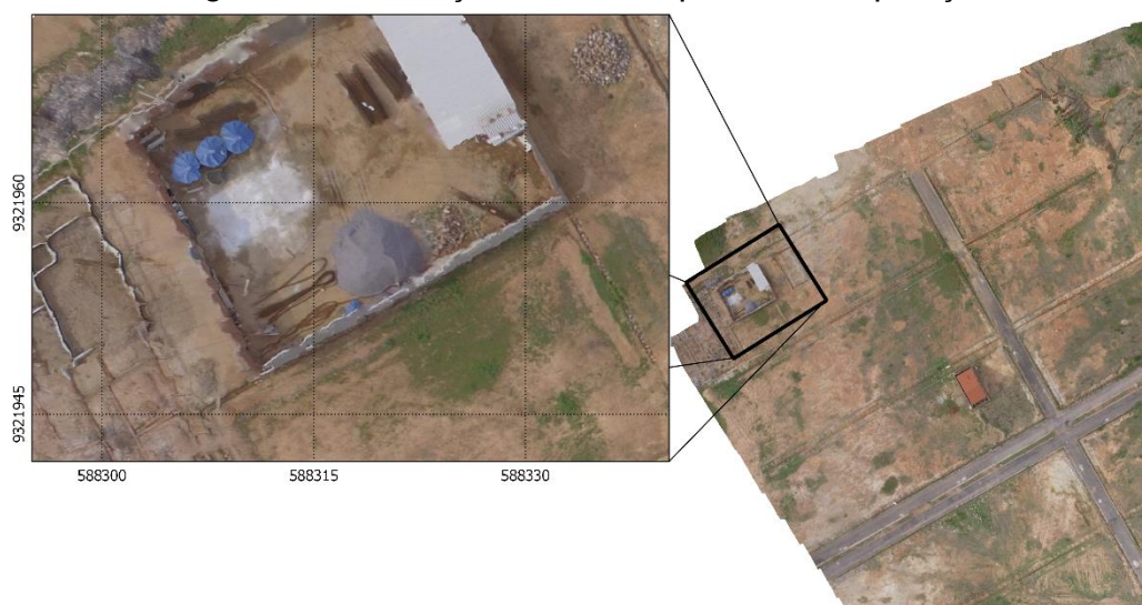
Figura 30 - Distorções devido à pouca sobreposição
