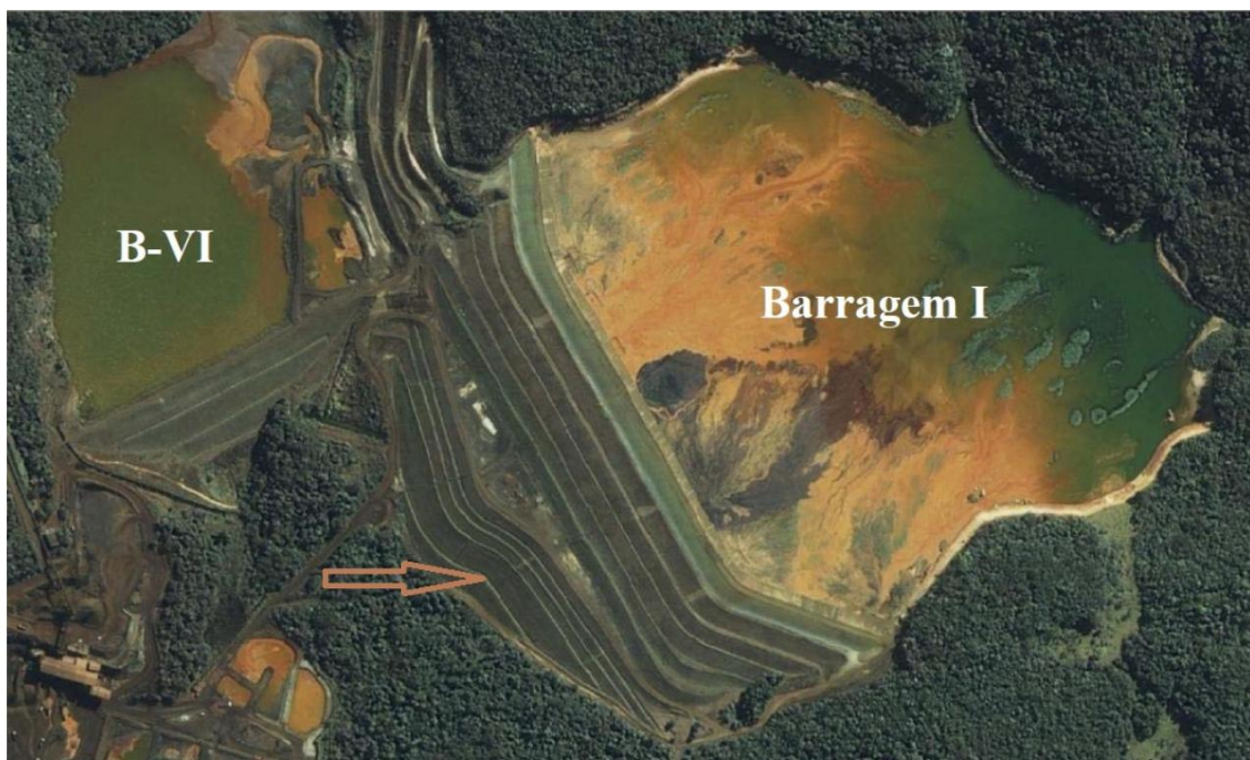
Figura 2: Vista aérea (planta) da barragem com indicação da região aproximada do início da ruptura
