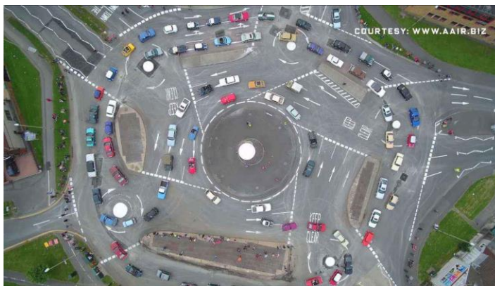
Figura 4 – Interseção de vários ramos e solução com rotatória
