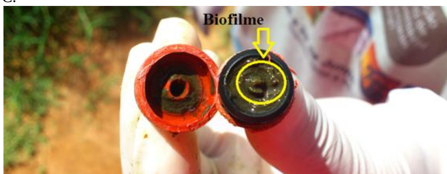
Figura 14. Ilustração do desenvolvimento de bioincrustação no interior dos gotejadores G1 (A), G2 (B) e G3 (C) que aplicaram água residuária doméstica tratada.
