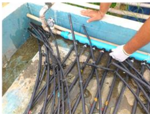
Figura 11. Ilustração da abertura do final das linhas laterais para limpeza das mesmas.
