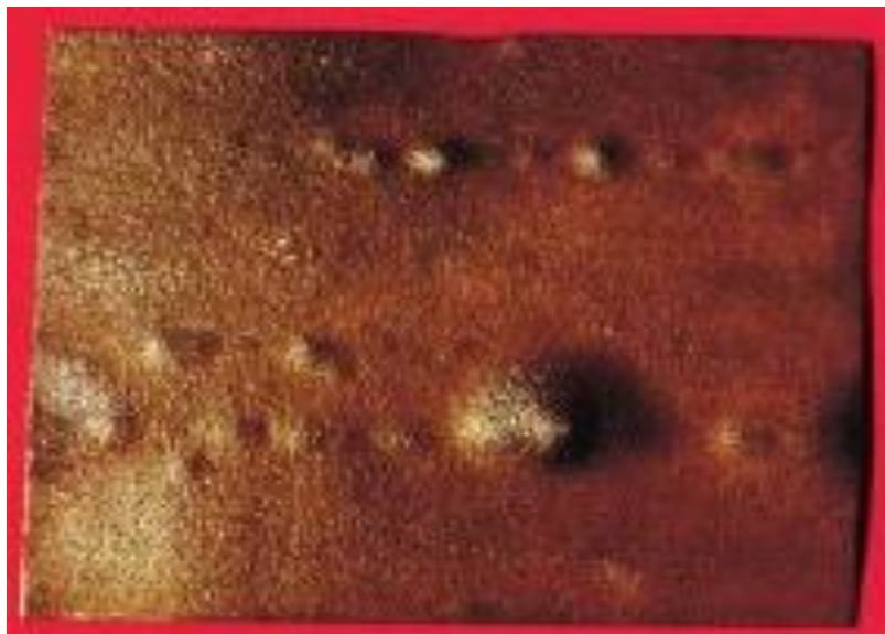
Figura 11: Chapa de aço-carbono com empolamento de hidrogênio.
