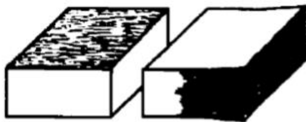
Figura 11: Corrosão por esfoliação
