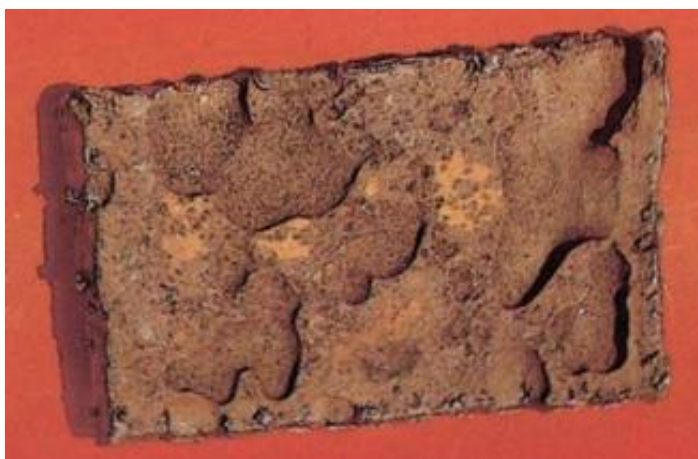
Figura 3: Corrosão por placas.
