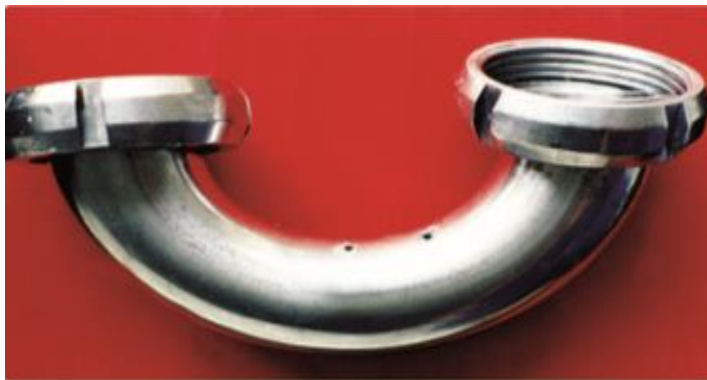
Figura 5: Corrosão por pites.
