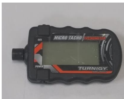
Figura 6. Tacômetro utilizado para medição de RPM das hélices. (Autoria própria, 2019)
