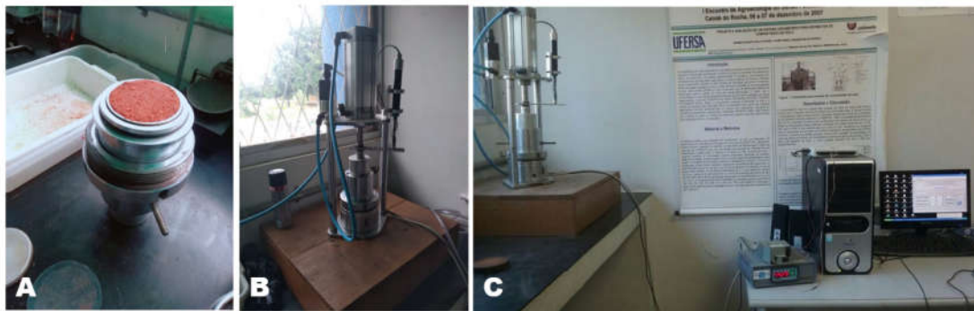
Figura 7 – A) Amostra não deformada dentro da célula oedométrica. B) Oedômetro. C) Sistema de acionamento do oedômetro e leitura das deformações.
