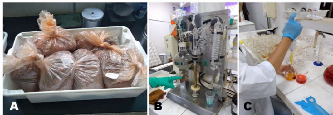
Figura 5 – Determinação do teor de carbono orgânico e nitrogênio no solo. A) Amostras deformadas. B) Determinação do teor de carbono orgânico. C) Determinação do teor de nitrogênio. Fonte: Arquivo pessoal, 2019.
