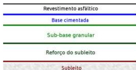
Figura 10: Estrutura do revestimento semirrígido.
