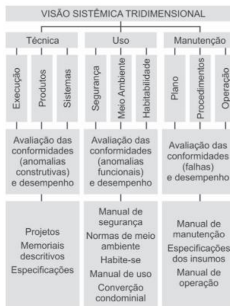
Figura 9- Esquema de visão sistêmica tridimensional para inspeção predial
