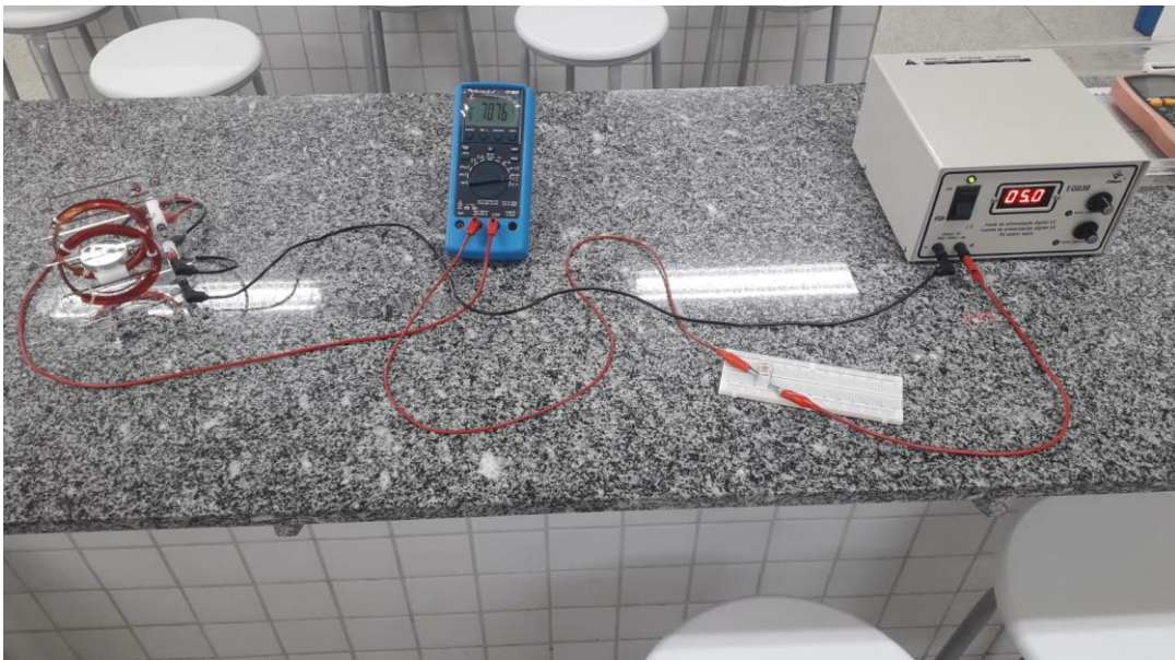
Figura 11 - Circuito montado para bobina de Helmholtz
