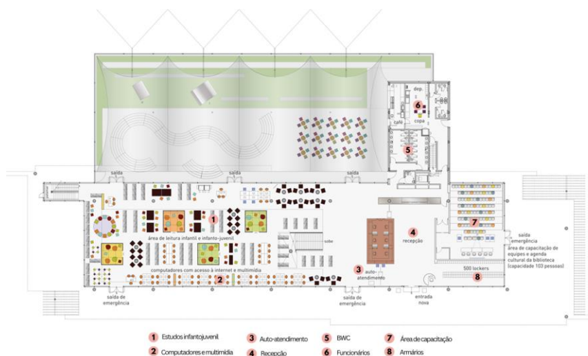
Figura 19: Planta baixa pavimento térreo e primeiro pavimento
