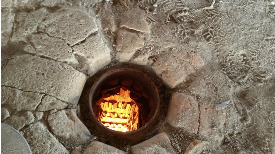
Figura 12: Processo de queima - forno contínuo tipo Hoffmann
