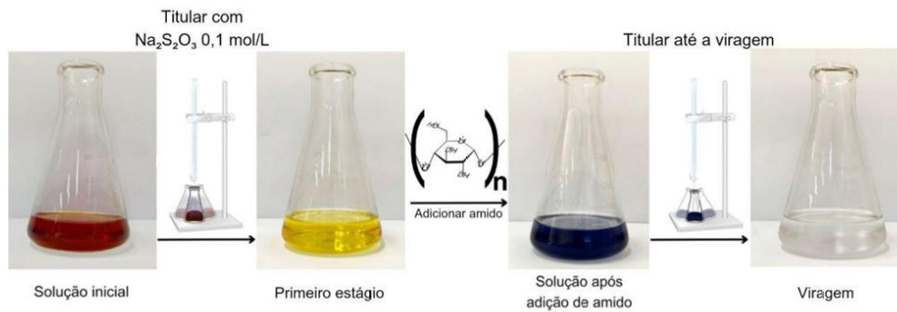
Figura 9 – Etapas para determinação do teor de cloro ativo na água sanitária.
