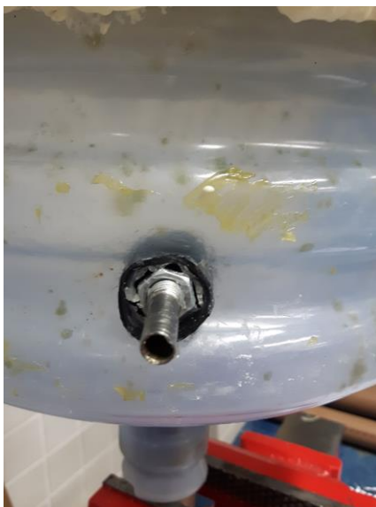
Figura 9 - Conexão de entrada do reservatório.
