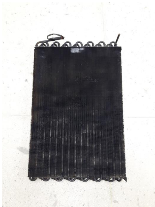
Figura 5 - Serpentina de Condicionador de ar.
