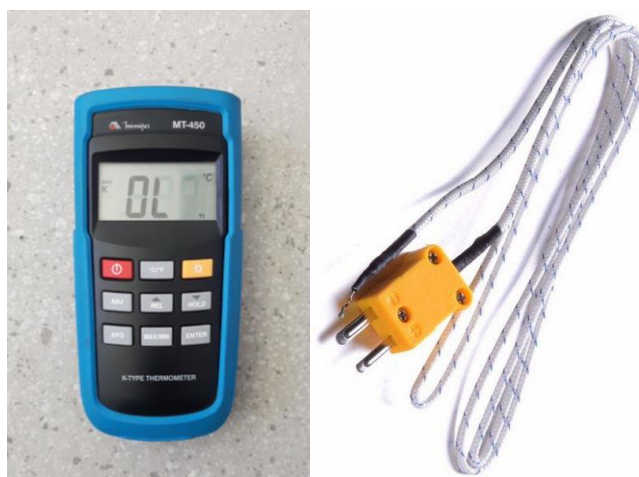
Figura 14 - Termômetro digital (MT-450) e termopar do tipo K.
