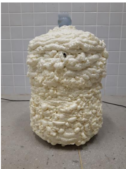
Figura 10 - Reservatório isolado com adesivo de Poliuretano.
