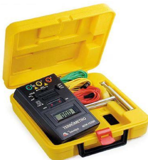
Figura 38- Terrômetro Minipa MTR-1520D
