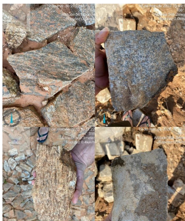
Figura 19: Agregados utilizados na pavimentação das estradas rurais de Luís Gomes-RN.
